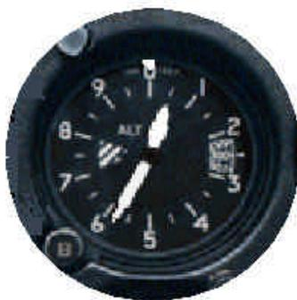
図 2.3 気圧高度計。
